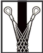
An beliebiger Stelle von Kabel-, Seil- oder Rohr angebracht und z. B. mit dem Zugseil verbunden, ermöglichen diese Strümpfe ein sicheres Nachziehen.
